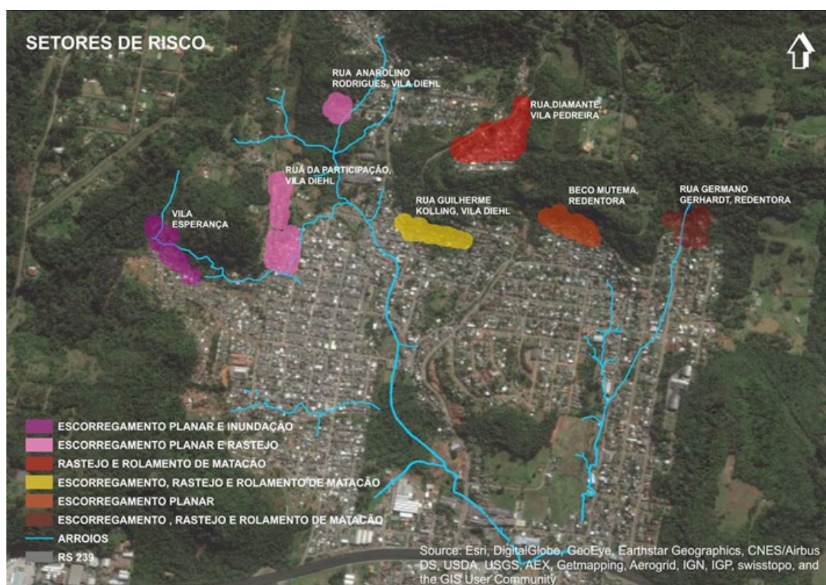
Figura 4 - Localização e caracterização dos setores de risco
